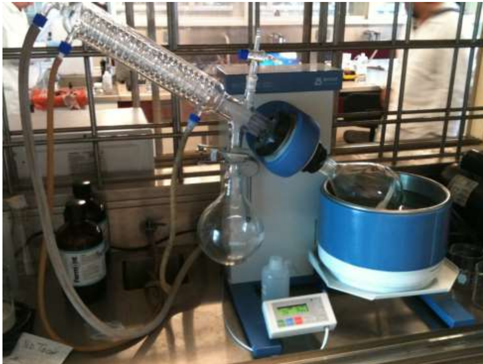
Figura 3.6 Rotovapor en el proceso de separación del diclorometano por destilación.
