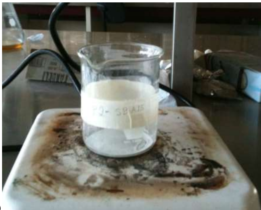
Figura 3.2 Secado de las partículas mesoporosas MCM-41 y SBA-15 al ser lavadas con etanol.
