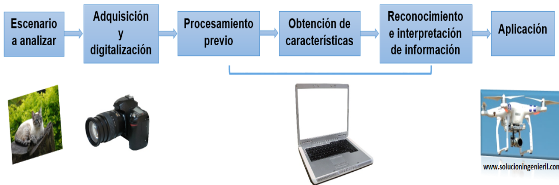
Figura 1 Etapas de un sistema de visión artificial (Ingenieril, 2021).
