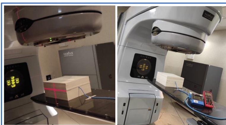
Figura 20. Procedimiento para la colocación y medición del plan de verificación con cámara Farmer y maniquí de placas de agua sólida. Colocación manual de barómetro y termómetro para realizar las anotaciones de los valores en cada medida.
