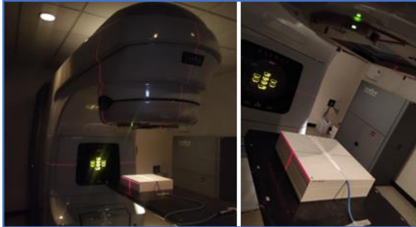
Figura 23. Posicionamiento y alineación del maniquí de placas de agua solida con la cámara de ionización tipo Semiflex insertada en la placa con orificio.
