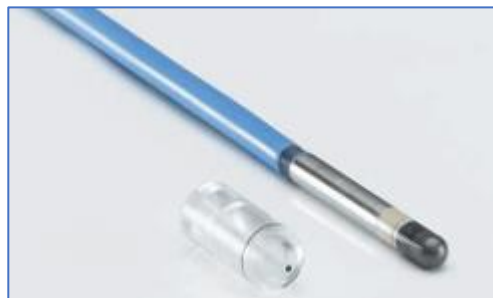
Figura 14. Cámara de ionización impermeable utilizada para dosimetría de referencia, tamaño más pequeño y mejor volumen sensible para mediciones de dosis precisas de energía de la marca PTW Semiflex tipo 301010.
