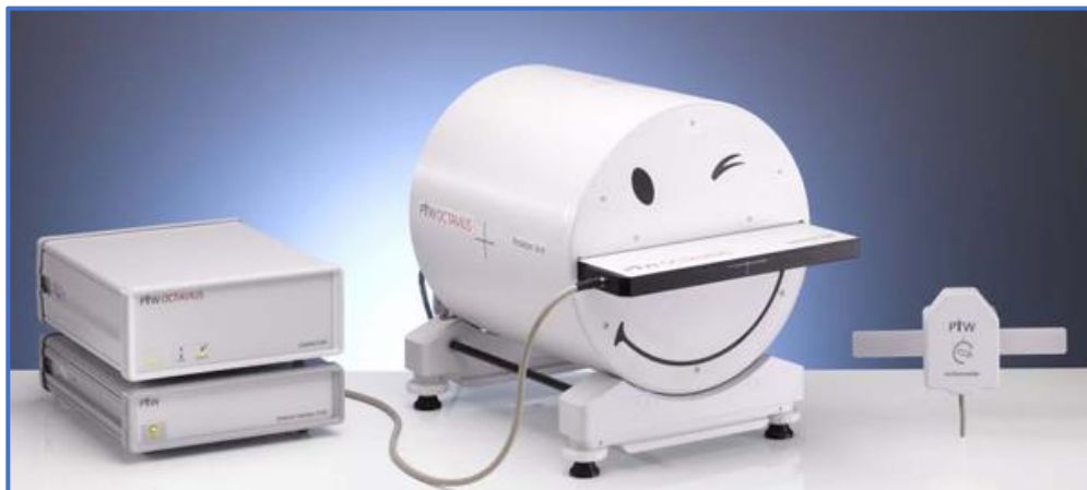
Figura 15. Sistema Octavius para control de calidad paciente específico, de izquierda a derecha se visualiza la unidad de control, interfaz del detector, unidad de control con detector insertado e inclinómetro de la marca PTW.
