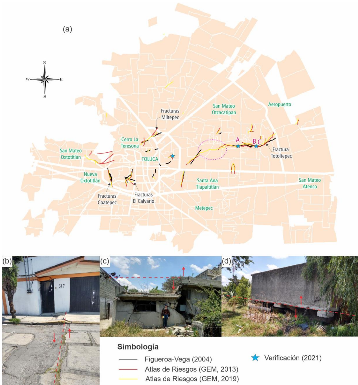
Figura 4.6. (a) Distribución de fracturas observadas por Figuroa-Vega (2004), GEM (2013) y GEM (2019) en el área metropolitana de la ciudad de Toluca. Se muestran fotografías de evidencia de movimientos diferenciales: (b) Desplazamiento vertical, (c) Fractura de casa-habitación por desplazamiento vertical y horizontal, (d) Zapatas de casa-habitación expuestas por subsidencia.
