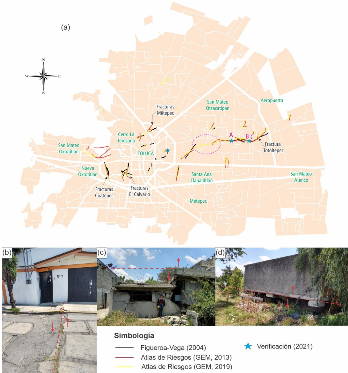
Figura 2.3. Distribución de fracturas observadas por Figueroa (2004), GEM (2013) y GEM (2019) en el área metropolitana de la ciudad de Toluca. Se muestran fotografías de evidencia de movimientos diferenciales: A Desplazamiento vertical, B Fractura de casa-habitación por desplazamiento vertical y horizontal, C Zapatas de casa-habitación expuestas por subsidencia.
