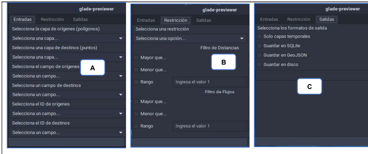
Figura 3.17: Prototipo 2, Figura 3.17-A: Ventana principal y pestaña de entradas, Figura 3.17-B: Pestaña de restricciones, Figura 3.17-C: Pestaña de formatos de salida, Fuente: Elaboración propia.
