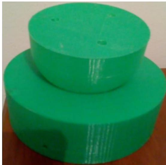
Figura 5.1 Cuenco y semiesfera de PLA para la estructura del emulador
