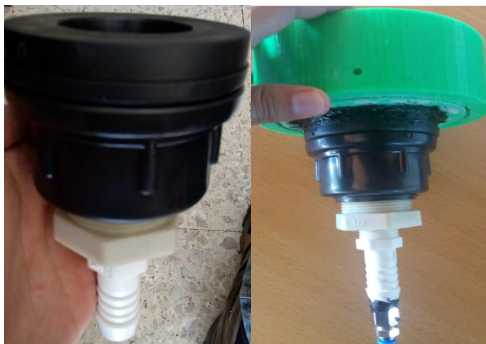
Figura 5.5 a) Brida y coples de polipropileno, b) Ensamblaje de brida en base del emulador
