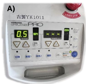
Figura 3. A) Configuración de láser CO 2 0.5W. B) Aplicación de ácido ortofosfórico combinado con irradiación láser CO 2 .
