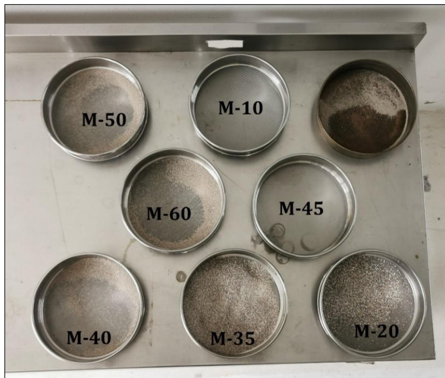
Figura 18. Mallas metálicas en prueba de tamizado números 10, 20, 35, 40, 45, 50 y 60.
