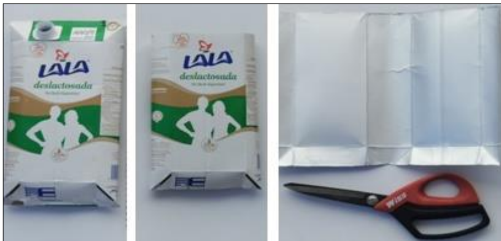
Figura 9. Corte de la parte superior y la base a los envases de Tetra Pak de desecho.
