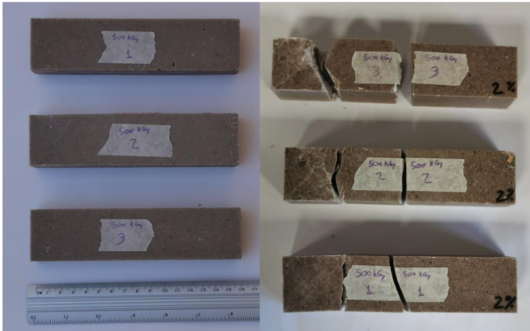
Figura A2.9. Probetas con 2% de Tetra Pak e irradiadas a 500kGy, antes y después de las pruebas mecánicas.
