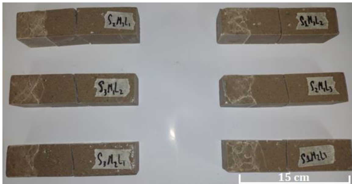
Figura A2.11. Probetas con diferentes combinaciones de tamaños de partículas de Tetra Pak, después de las pruebas mecánicas.
