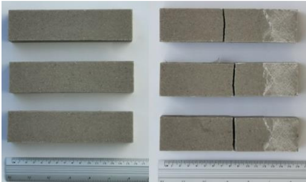
Figura A2.1. Probetas de concreto control, antes y después de las pruebas mecánicas.
