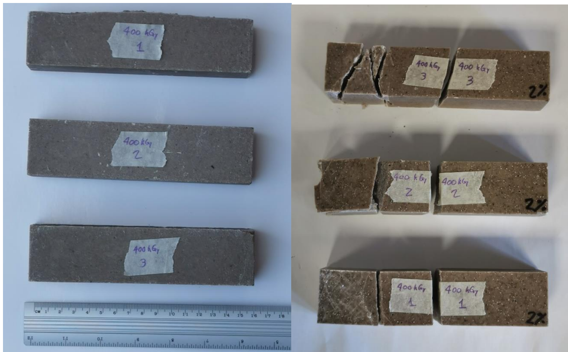
Figura A2.8. Probetas con 2% de Tetra Pak e irradiadas a 400kGy, antes y después de las pruebas mecánicas.
