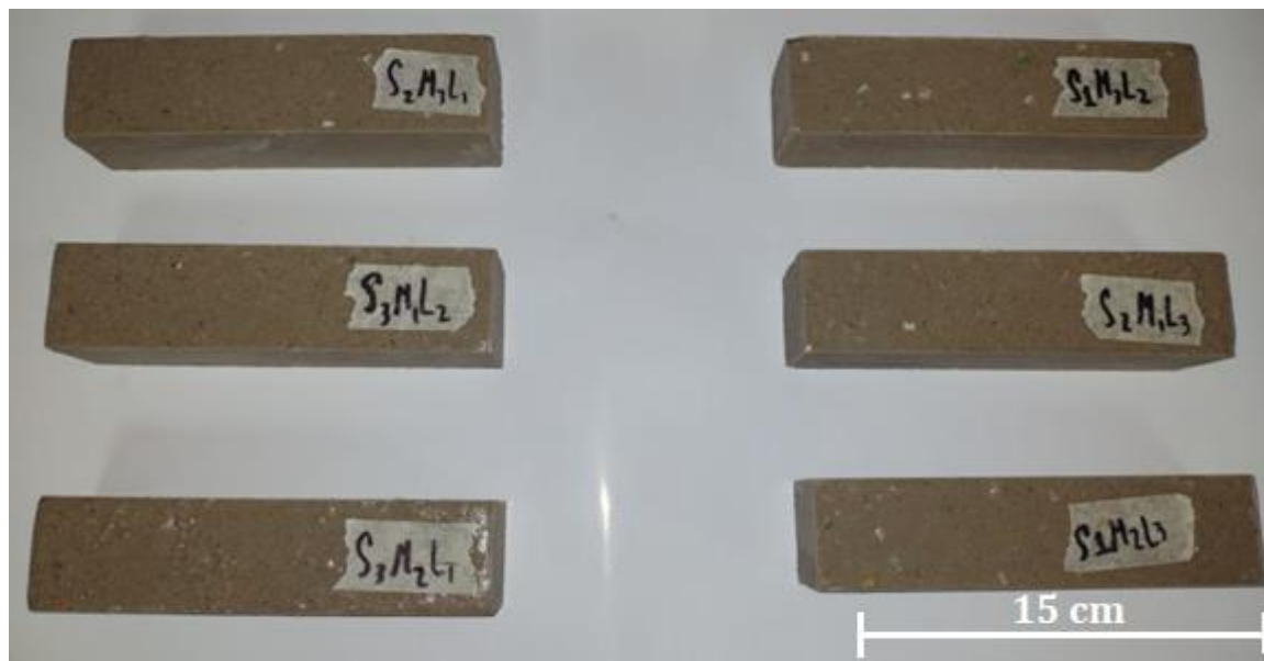
Figura A2.10. Probetas con diferentes combinaciones de tamaños de partículas de Tetra Pak.
