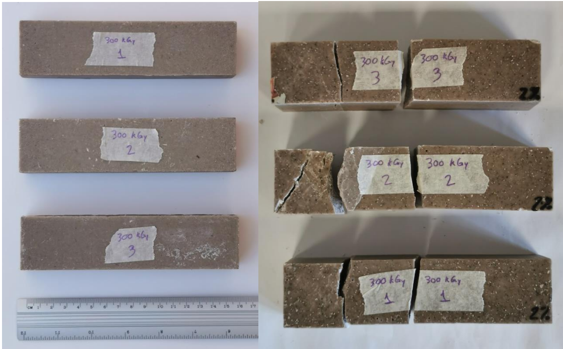
Figura A2.7. Probetas con 2% de Tetra Pak e irradiadas a 300kGy, antes y después de las pruebas mecánicas.
