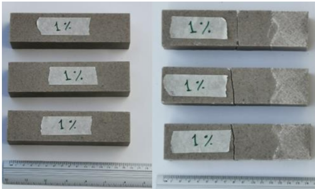
Figura A2.2. Probetas con 1% de Tetra Pak, antes y después de las pruebas mecánicas.
