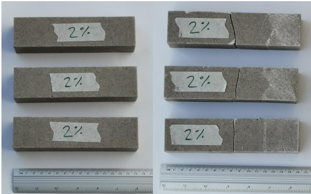
Figura A2.3. Probetas con 2% de Tetra Pak, antes y después de las pruebas mecánicas.
