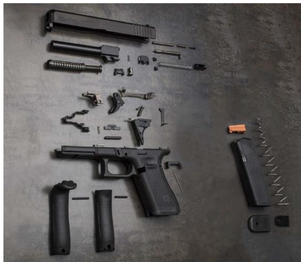
Imagen 12. Desarme Especializado del arma corta.
