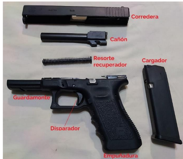
Imagen 10. Desarme parcial del arma corta.
