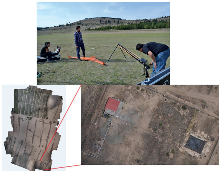
Figura 9.3 Protocolo de preparación y lanzamiento de RPAS Ligeros y producto resultante del vuelo: mosaico de ortofotos de alta resolución espacial (2.5 cm)
