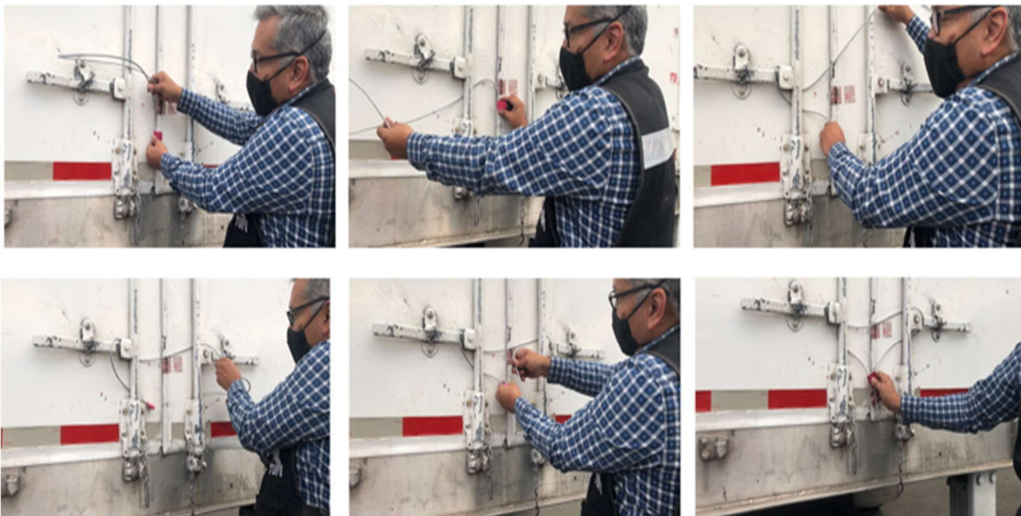
Imagen 7 Sánchez, M.I. (2021). Colocación de sellos VVTT.
