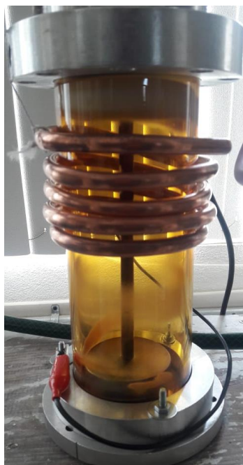
Figura 4.3. Reactor con polialilamina sintetizada por plasma a 100 W.
