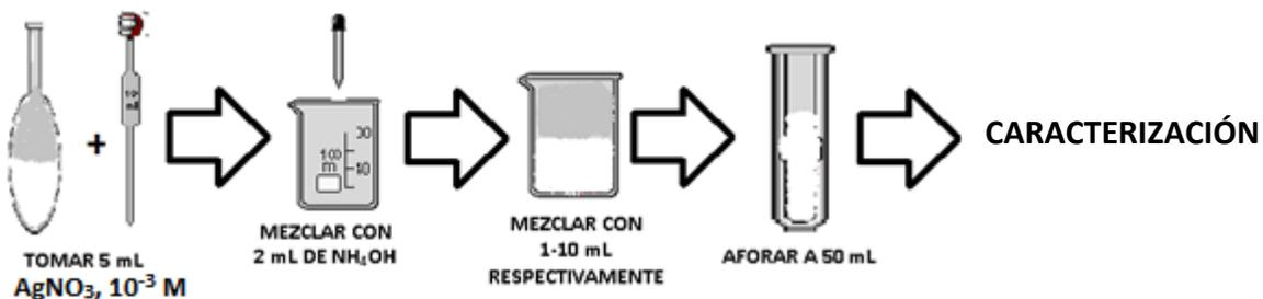
Figura 19. Obtención de nanopartículas de plata a partir de extracto acuoso de *O. ficus-indica* y solución acuosa  $10^{-3}$  M de  $\text{AgNO}_3$
