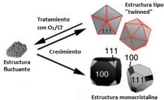
Figura 5. Mecanismo de obtención de semillas monocristalinas <sup>26</sup>.
