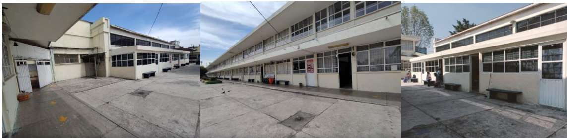
Fig. 25-27 Umbrales o guías. Carencia de llamadas que informen si el usuario que se desplaza está en el camino correcto y en la dirección adecuada.
