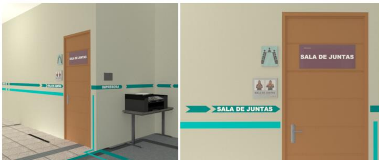
Ilustración 77 Vista de aplicación de señales pictóricas, letreros y braille direccionado por piso y muros (fuente propia).
