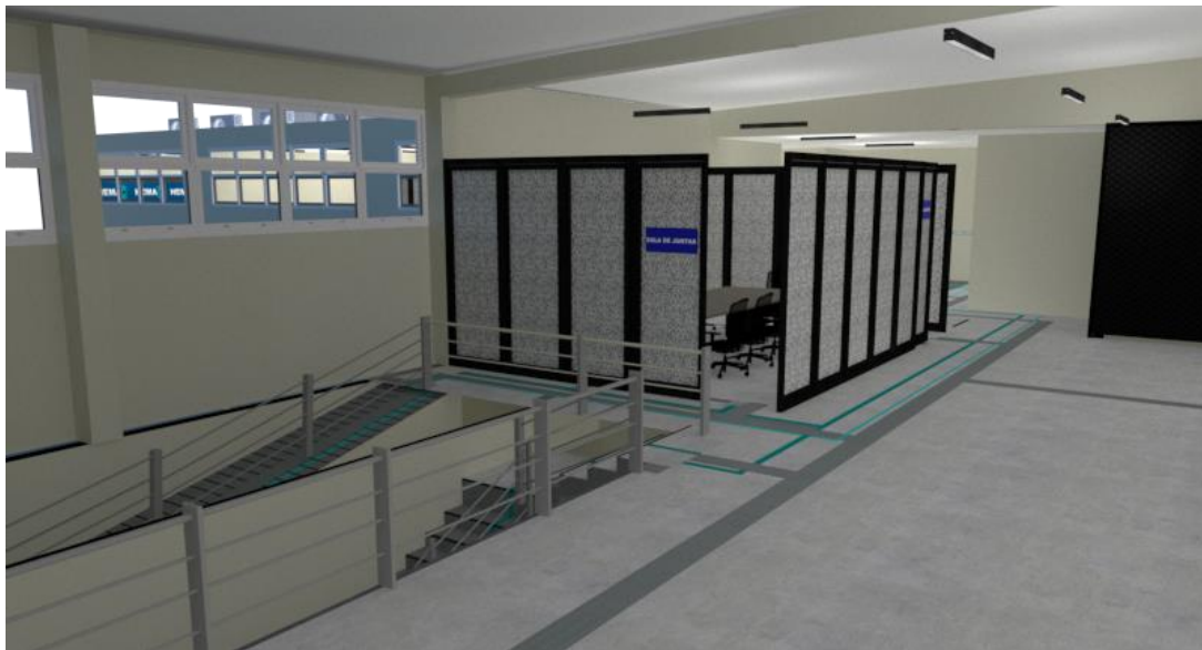
Ilustración 71 Vista de guías podó táctiles conectando las oficinas, la rampa y escaleras (fuente propia).
