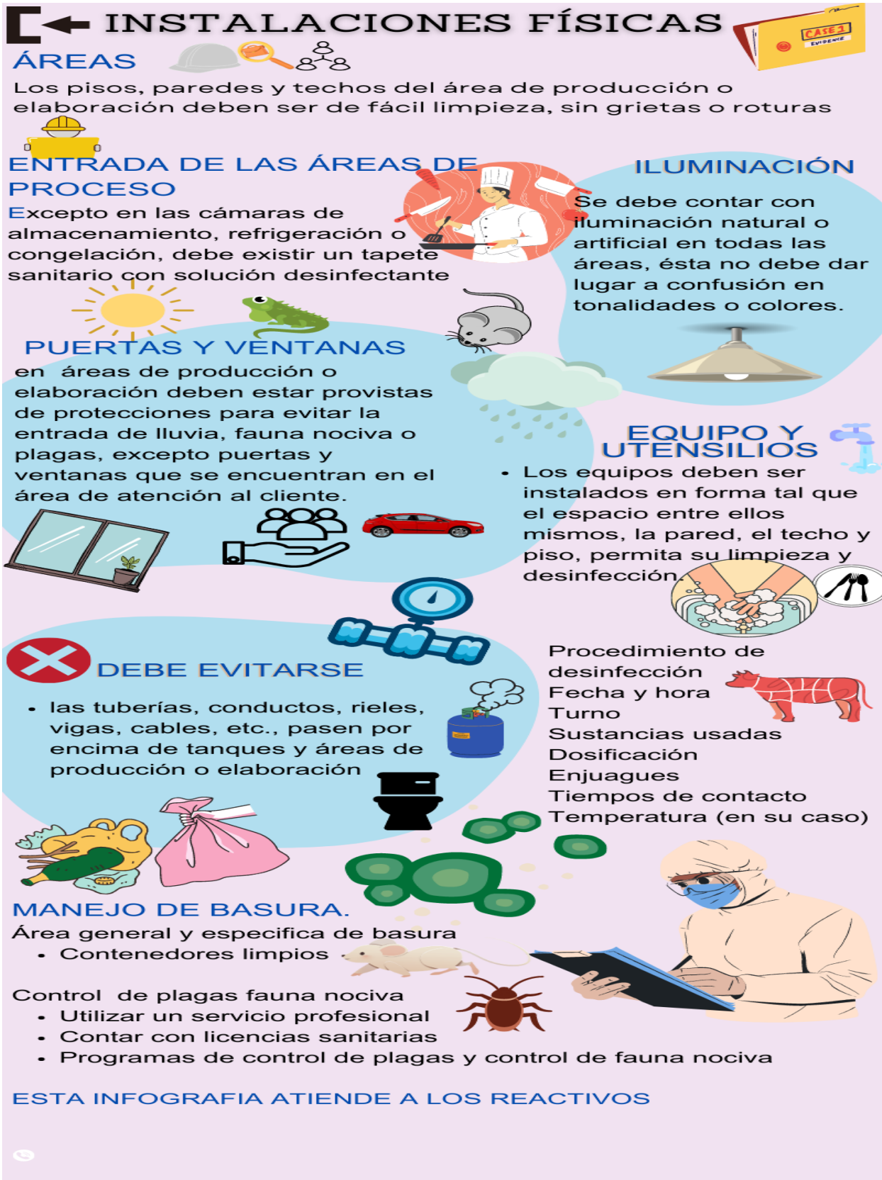
Figura 5. Infografía de instalaciones físicas. (25) (27)
