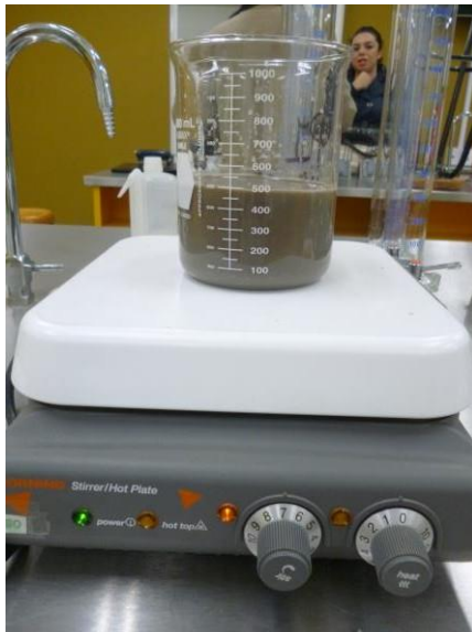
Fuente: toma propia 30-08-2013 Proceso de agitacion para la separacion de arcillas para la obtencion de texturas
