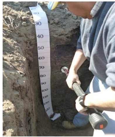
Funte: toma propia 25-01-2013 Obtencion de muestras de los horizontes del perfil con nucleador
