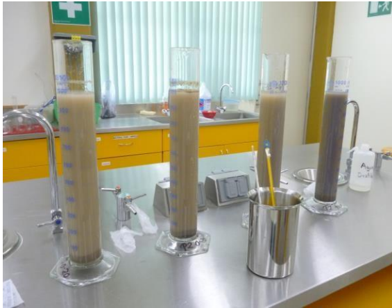
Fuente: toma propia 30-08-2013 Cilindros en reposo para la obtención de lecturas de textura
