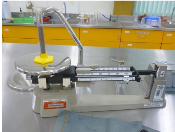
Fuente: toma propia 17-07-2013 Peso inicial para determinar DA por el método de la probeta
