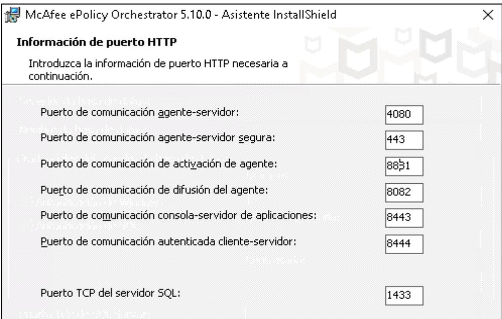
Figura 16: Puerto de comunicación definidos para la comunicación de McAfee ePO.
