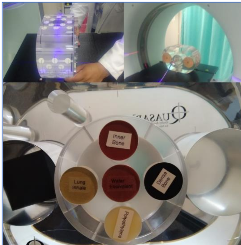
Figura 5. 24 Arreglo experimental para las pruebas de comisionamiento del RTPS acorde al IAEA-TECDOC-1583.
