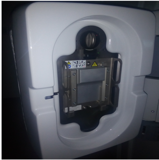
Figura 3.10: Filtro corbatín ( bowtie ) empleado en el protocolo Low Dose Thorax .
