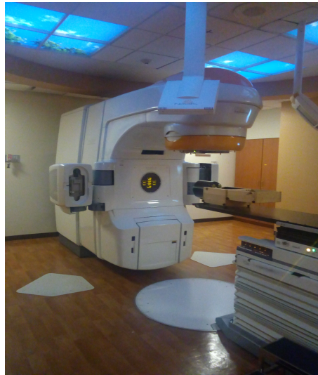
Figura 3.1: Acelerador lineal Novalis Tx del CMABC empleado en los tratamientos de SBRT.
