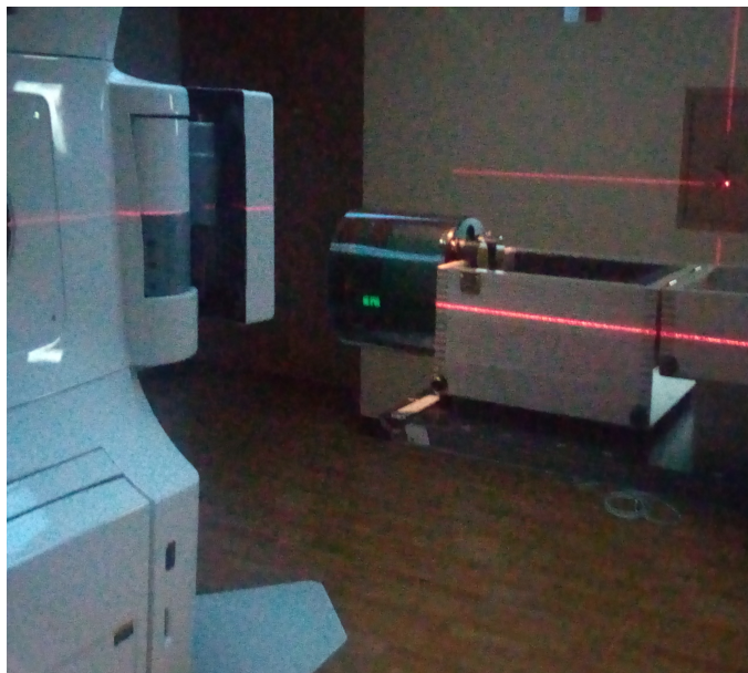
Figura 3.9: Posicionamiento del Catphan 504 en el acelerador lineal para la adquisición de imágenes.
