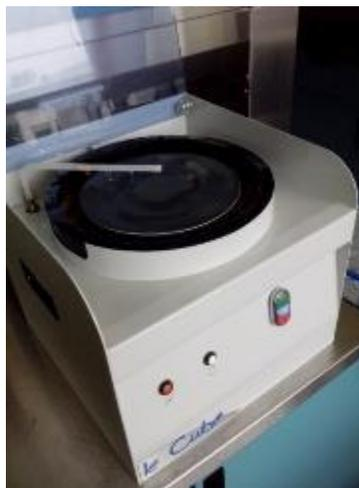
Figura 35. Pulidora de disco rotatorio, marca Le Cube.
