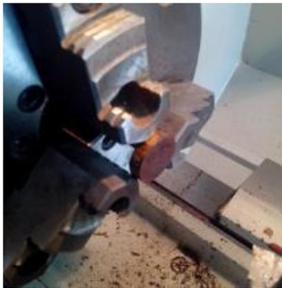
Figura 14. Chuck de 3 mordazas con pieza para carear.
