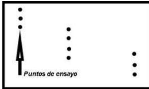
Figura 56. Representación de puntos de ensayo de dureza en la muestra de acero.
