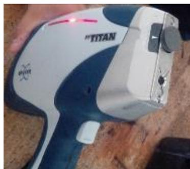
*Figura 25. Pistola FRX realizando prueba en acero SISA 4140.*
