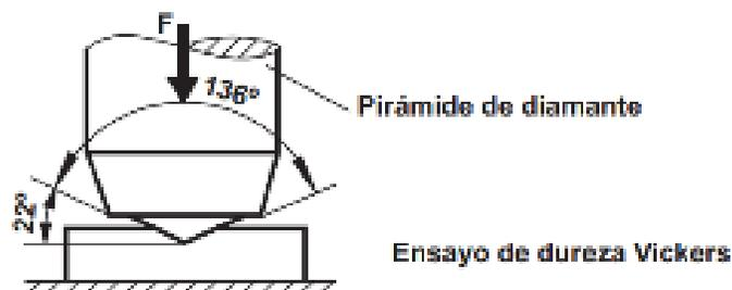
Figura 57. Ángulo de indentación del diamante en ensayo Vickers.
