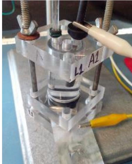
Figura 67. Celda electroquímica con los electrodos y cables de conexión.
