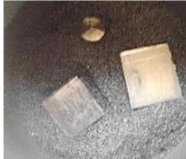
Figura 20. Colocación de muestras de acero en sales de boruro.
