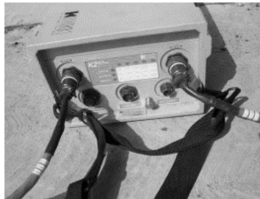
Figura 3.11. Grabadora Kinometrics. (Valdés et al, 2010)
