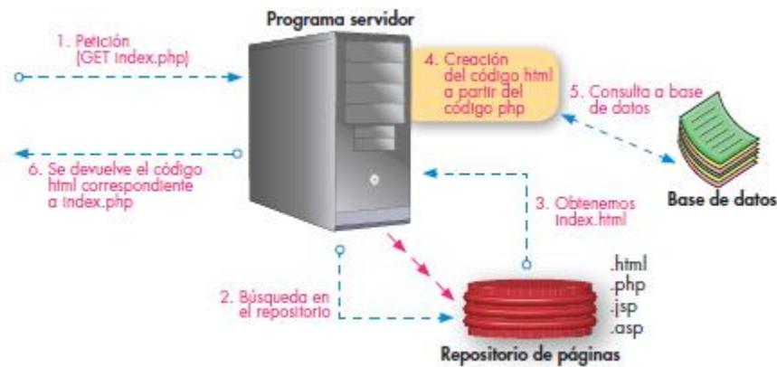
Figura 8. Esquema básico del funcionamiento del servicio web con páginas dinámicas
