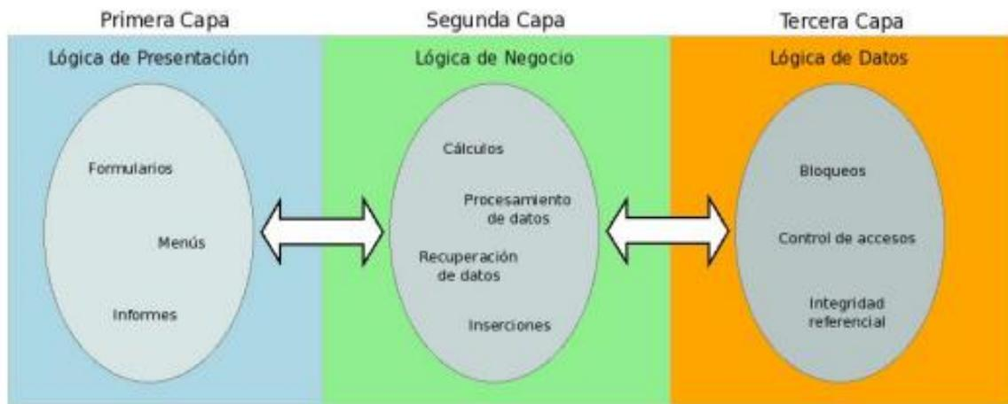
Figura 13. El Modelo Cliente/Servidor multicapa.
