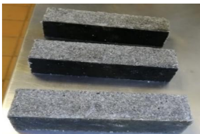
Fig. 2.8. Probetas con partículas de llanta (R/M-p) lote D
