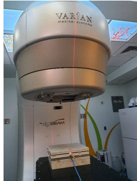
Figura 4.11. Esquema (lado izquierdo) y fotografía (lado derecho) del maniquí con artefactos en el ALE, con CI y OSL.
