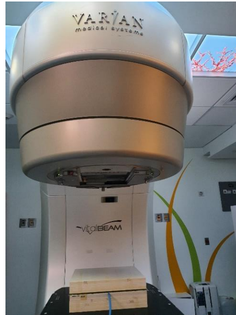
Figura 4.9. Esquema (lado izquierdo) y fotografía (lado derecho) del maniquí de referencia en el ALE, con CI y OSL.
