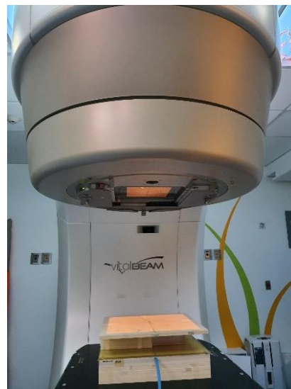
Figura 4.10. Esquema (lado izquierdo) y fotografía (lado derecho) del maniquí con heterogeneidades en el ALE, con CI y OSL
