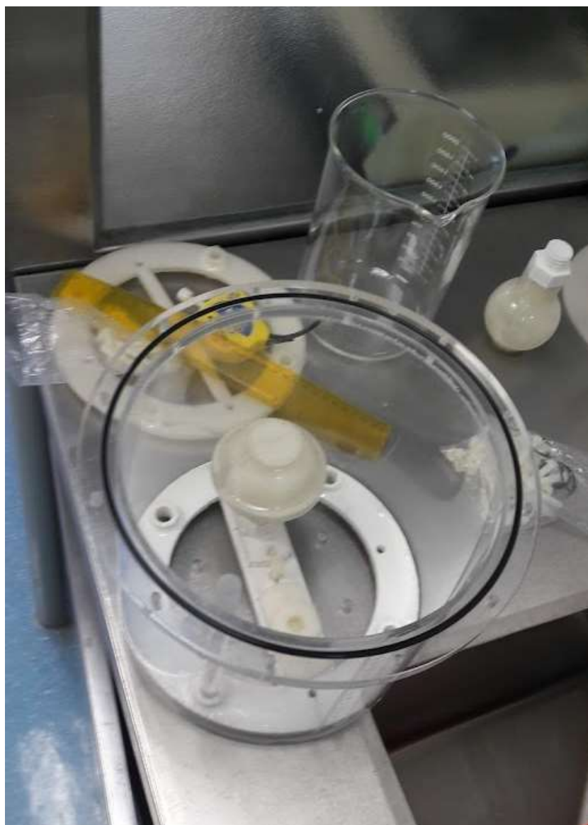
Figura 1. Segundo maniquí en proceso de preparación, se aprecia una de las esferas de 198 ya rellena y fijada en el soporte
