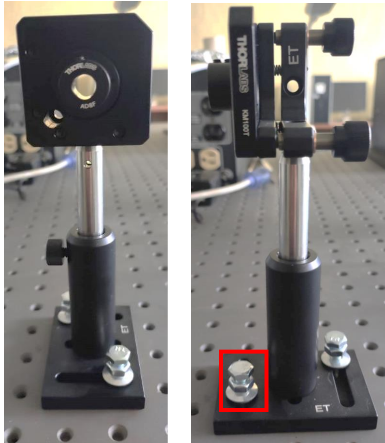
Figura 30. Kit de instalación para montaje del láser sobre mesa óptica. Altura ajustada a 8cm, se logra observar los tornillos fijadores para la mesa óptica.
