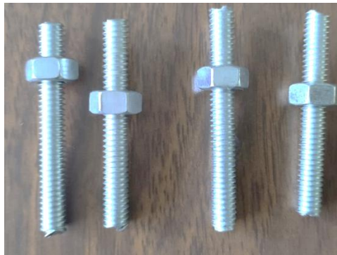
Figura 32. Varillas roscadas de acero galvanizada de \varnothing \frac{1}{4} In y 5cm de alto.
