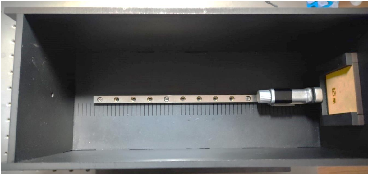
Figura 47. Vista superior de la parte interna del dispositivo, donde se aprecia el colimador, el riel y el clip ajustable.
