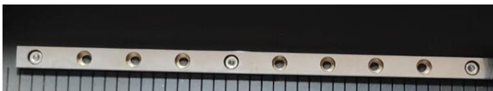
Figura 27. Riel incorporado al sistema que permite cambiar la distancia del portaobjetos y el láser.
