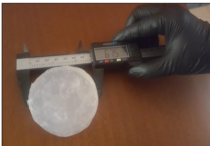
Figura 5.7. Medida del diámetro de la celulosa bacteriana después de ser lavada con NaOH al 1%.
