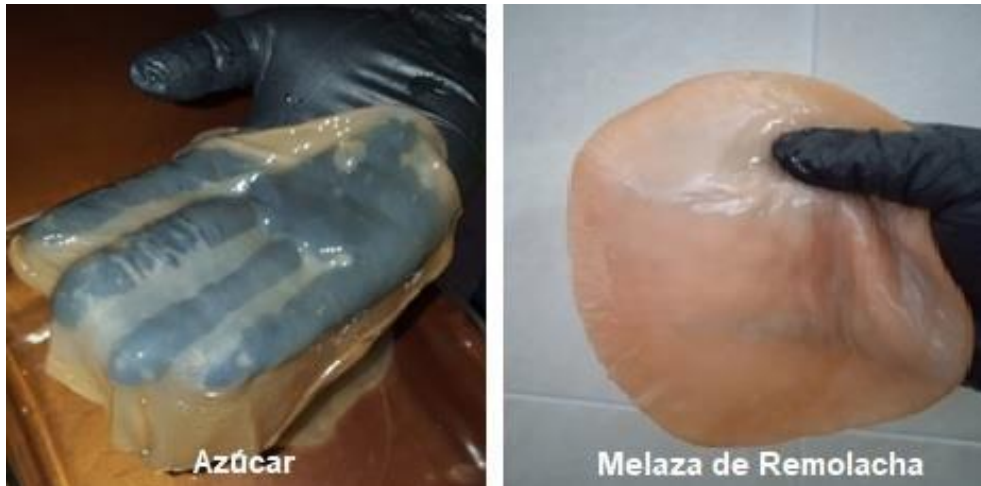
Figura 5.3. Producción de celulosa bacteriana con azúcar y con melaza de remolacha, como fuentes de carbono.
