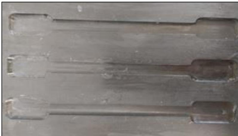
*Figura 3:2 Molde para la elaboración de probetas.*
