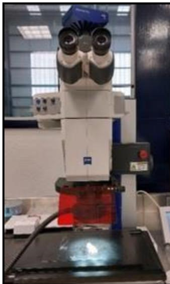
*Figura 4:1 Microscopio óptico AXIO Zoom V16.*
