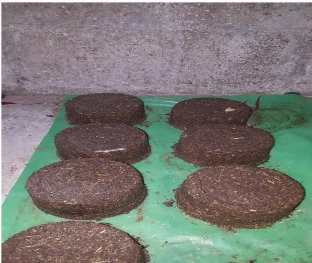
**Figura 11. Secado de los bloques**
