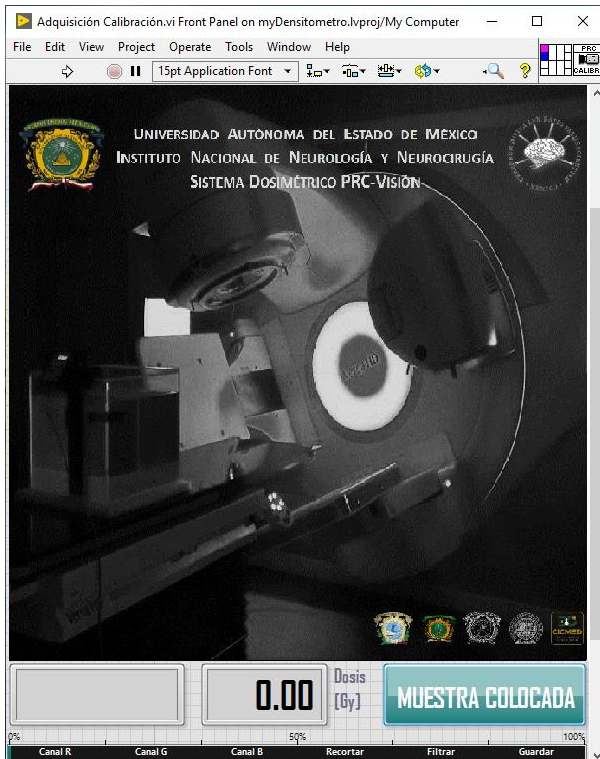
GUI del sistema de visión. Al centro se despliegan las imágenes de PRC; en la parte inferior un indicador del estatus de los dispositivos, un indicador de la dosis en la muestra y un control de inicio de escaneo cuando la muestra siguiente se ha colocado. Finalmente, una barra de progreso.
