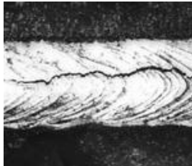
Figura 12. Defectos lineales en cordón de soldadura.
