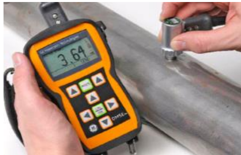
Figura 7. Método de medición de espesores por ultrasonido.
