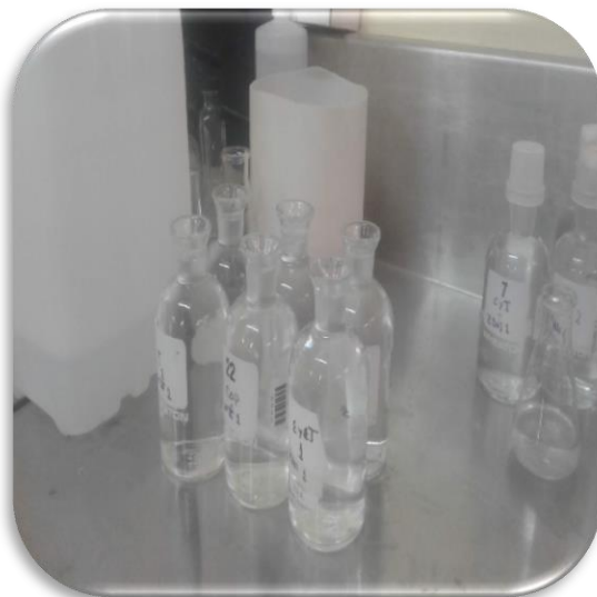
Imagen 23: Preparación de frascos winkler para DBO_5 .
