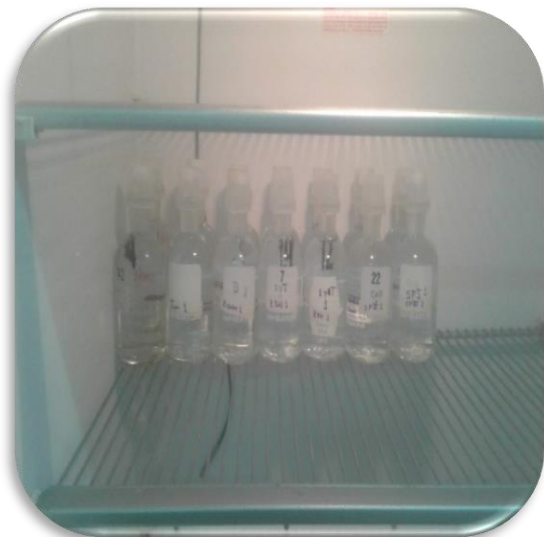
Imagen 24: Frascos winkler para DBO_5 puestos a incubar.
