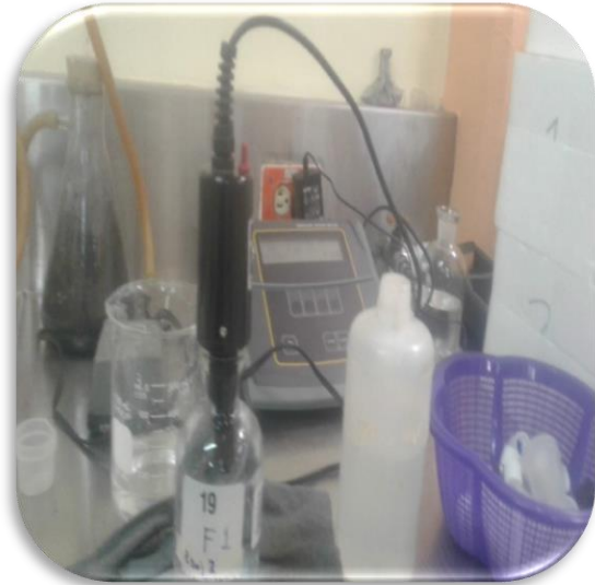
Imagen 22: Medición de oxígeno disuelto inicial para DBO_5 mediante el método electroquímico..
