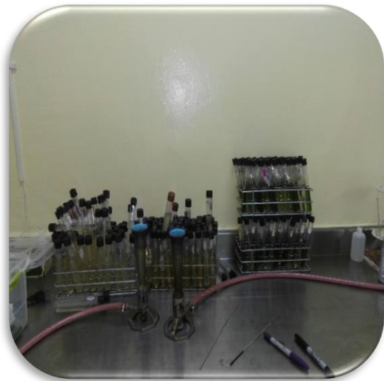
Imagen 16: Resiembra de tubos para prueba confirmatoria del Gpo Coliforme.
