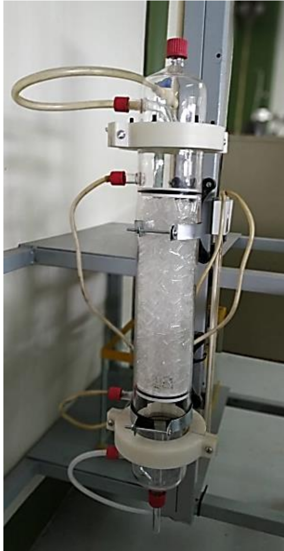
Figura 23. Torre de absorción empacada de la Facultad de Química, UAEMéx.
