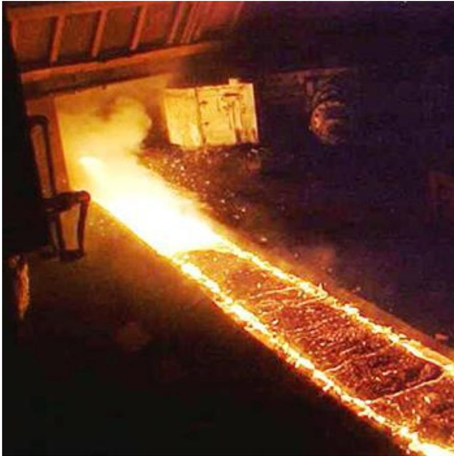
Figura 4. Canal para conducción de Arrabio y Escoria (Saint-Gobain, sin fecha).
