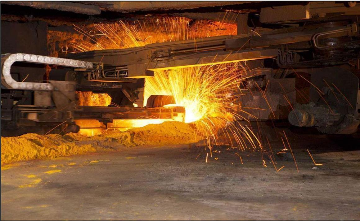
Figura 2. Taladro neumático perforando Tapón Refractario en una piqueta (Tapping Measuring Technology, 2018).
