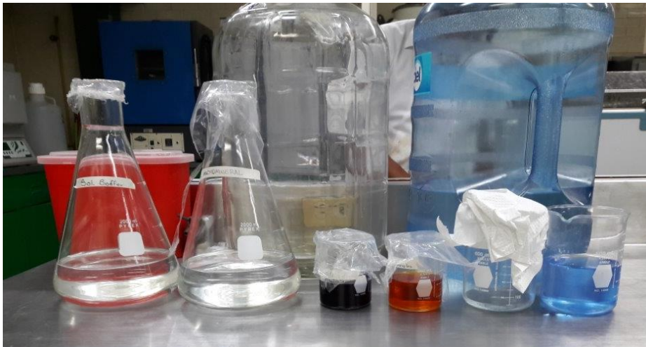
Fig. 5 Preparación de soluciones (de izquierda a derecha; solución buffer, solución macromineral, resazurina, solución micromineral, agua destilada, solución nutritiva final).
