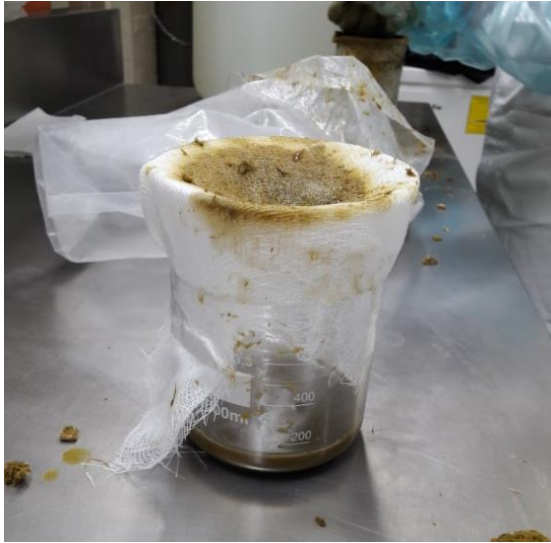
Fig. 4 Filtración de heces
