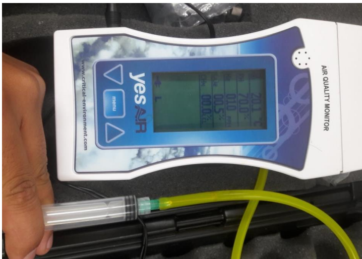
Fig. 9 Medición de \text{CH}_4 , \text{CO}_2 y \text{H}_2 con MONITOR de calidad del aire YesAIR
