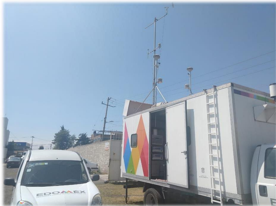
Imagen 15: Estación de Monitoreo Atmosférico (Unidad móvil) de la RAMA-ZMVT.
