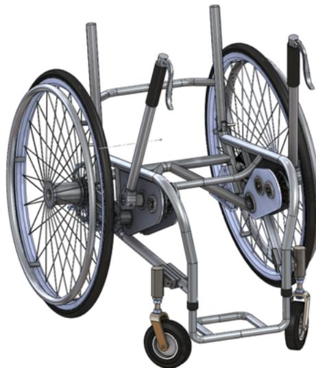
Figura 1.25: Dispositivo de palanca sin fase de recuperación [14].
