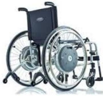
Figura 1.4: Silla de ruedas con propulsión asistida [4].
