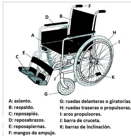
Figura 1.3: Principales partes de una silla de ruedas manual [3].
