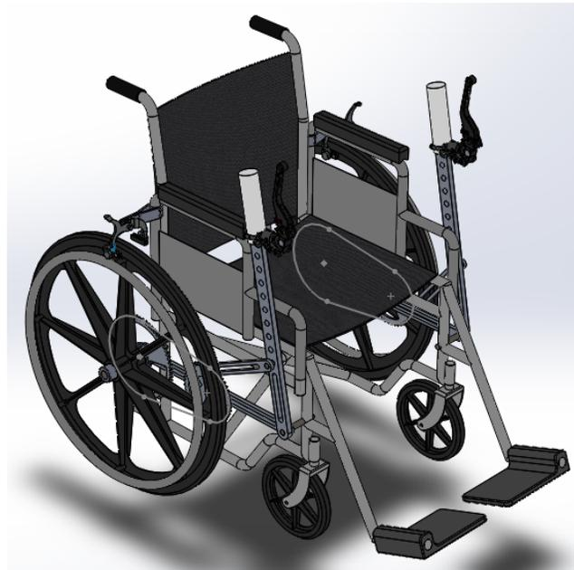
Figura 3.20: Silla de ruedas con el dispositivo de propulsión diseñado montado en cada lado.
