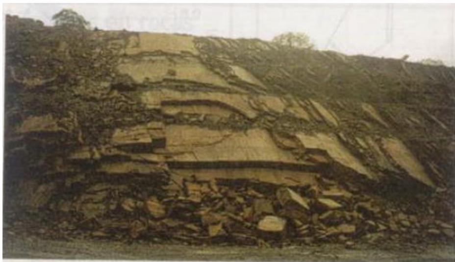
Figura 3.2. Escenario de máxima susceptibilidad, donde coincide la dirección de echado de los estratos con la dirección de la pendiente del terreno (Foto tomada por L. González de Vallejo).
