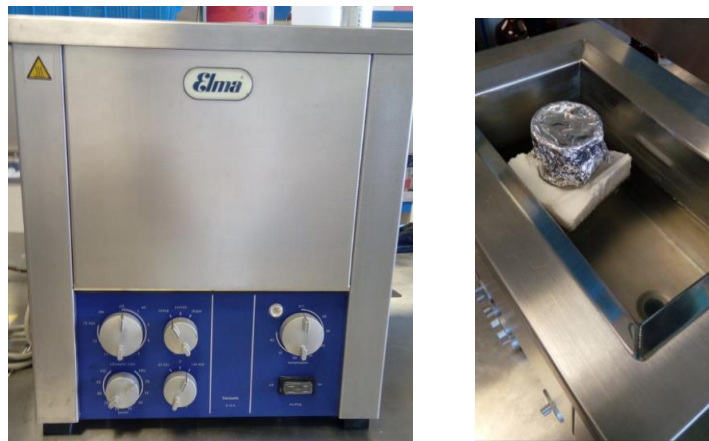
Figura 3-2 Equipo de ultrasonido y representación de cómo se lavaron los sustratos
