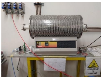
Figura 0-9 Horno tubular utilizado para el tratamiento térmico de las muestras.
