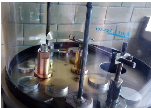
Figura 3-3. Elementos que constituyen al sistema de evaporación térmica.
