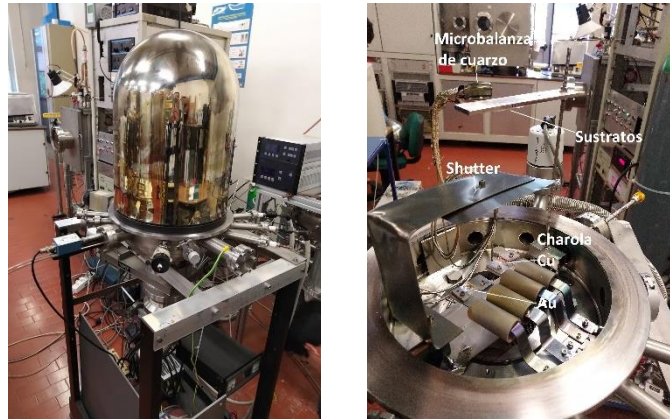
Figura 0-1 Sistema de Evaporación Térmica localizado en el Istituto Nazionale di Fisica Nucleare (INFN-Legnaro).
