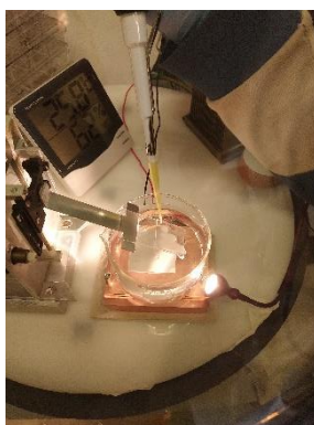
Figura 0-6 Colocación con la micropipeta de la solución de nanoesferas sobre el sustrato de vidrio.
