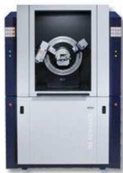
Figura 3-14 Difractómetro de Rayos X, Bruker D8 Advance, como el que se localiza en el Instituto de Física de la UNAM.
