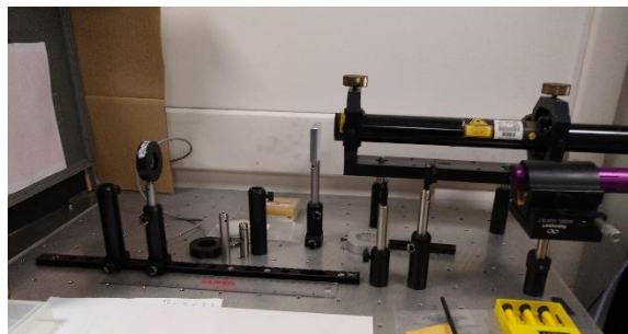
Figura 0-9 Arreglo óptico utilizado para la obtención del patrón de difracción de las máscaras. Los elementos utilizados fueron: Láser ( \lambda = 403 \text{ nm} ), diafragma, muestra, pantalla, lente ( f=50\text{mm} ), cámara CCD.
