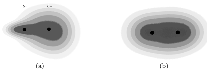
Figura 1.3: Gráfico de una molécula polar (a) y una molécula no polar (b) [16].
