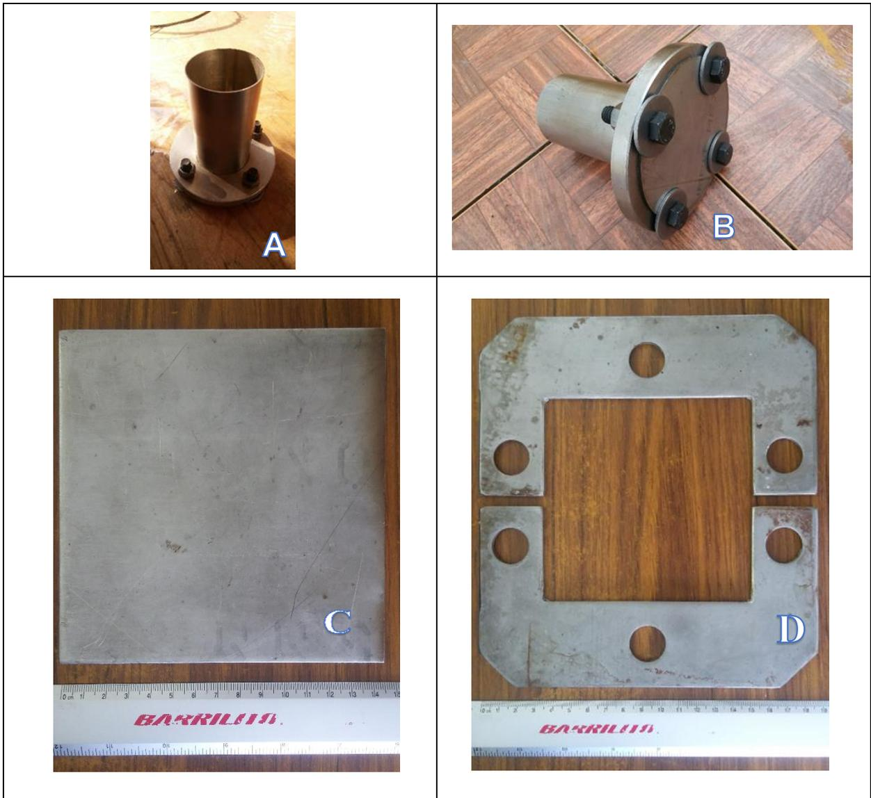
**Figura 4.3.** A, B, C, D. Moldes utilizados para el método de termocompresión en placa
