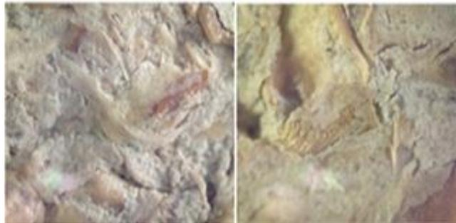
**Figura 3.3.** Composite con fibras de cáscara de piña como carga.
