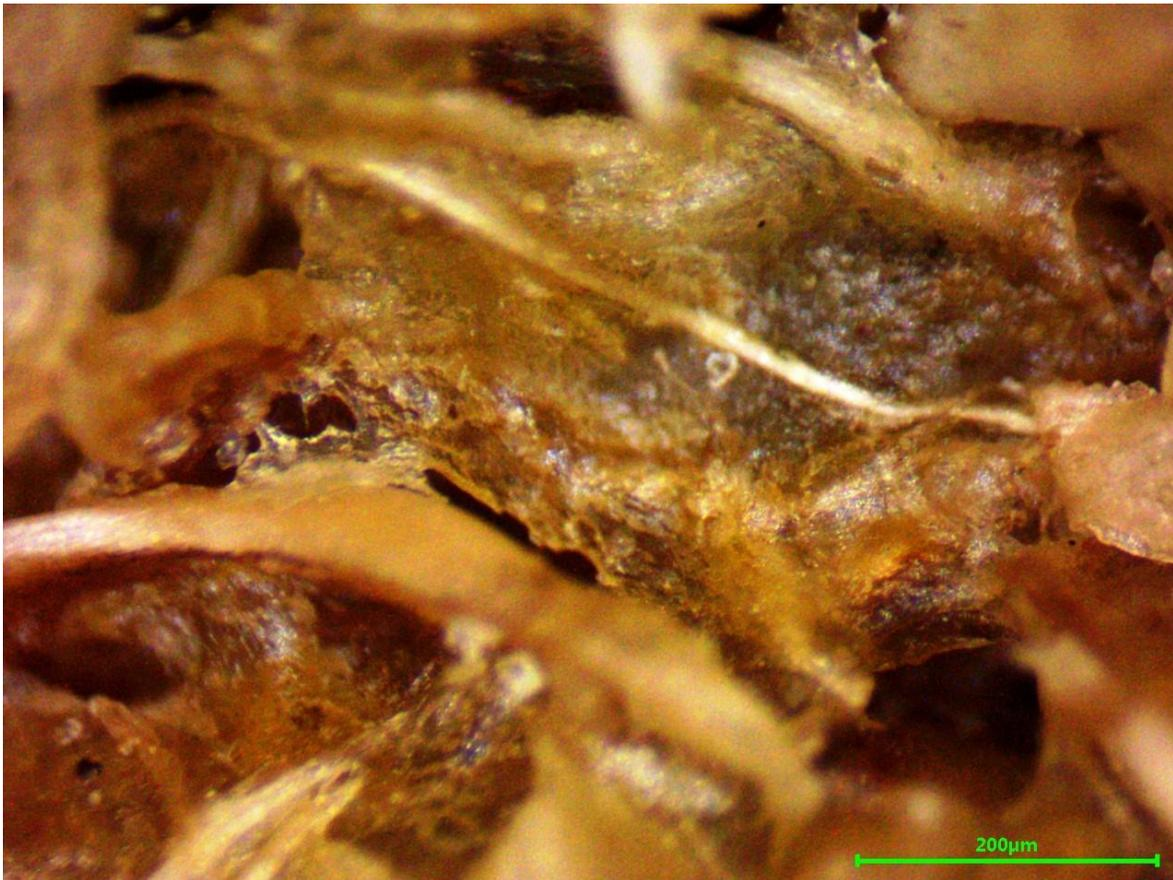
**Figura 4.10.** Estructura del Bipolímero/Cáscara de piña imagen tomado con estereoscopio
