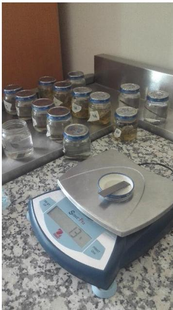
La prueba se llevó a cabo con 5 muestras a través de un procedimiento adaptado de la Norma ASTM D570-98. Las probetas se cortaron con las siguientes dimensiones: 60 x 10 mm y se pesaron, después fueron sumergidas en agua destilada a temperatura ambiente, las muestras se pesaron en diferentes intervalos de tiempo y el aumento de peso correspondió a la absorción de agua de la muestra (A %).
