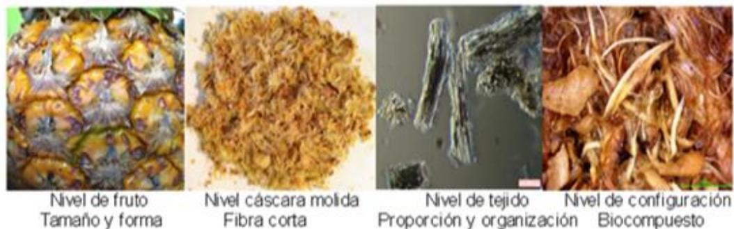
**Figura 3.2.** Dimensionamiento (macro y micro) de la cáscara de piña
