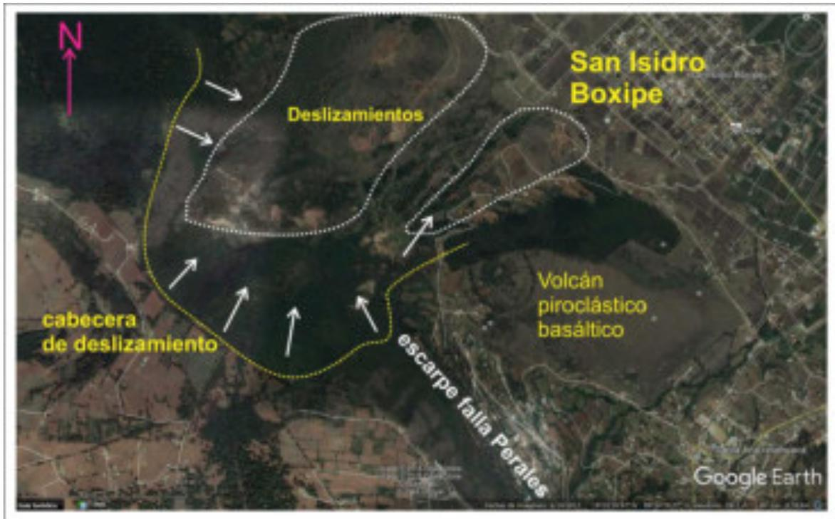
**Figura 4.22** - Deslizamiento San Isidro ubicado en el escarpe de la falla Perales
