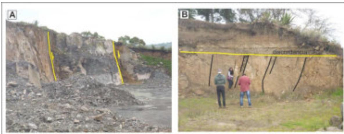
**Figura 5.10** - Fallas y fracturas San Felipe. A, fracturas y fallas que cortan a andesitas en las cercanías del volcán Til. B, fallas y fracturas NW-SE que son cubiertas discordantemente por paleosuelos y depósitos de cenizas volcánicas.
