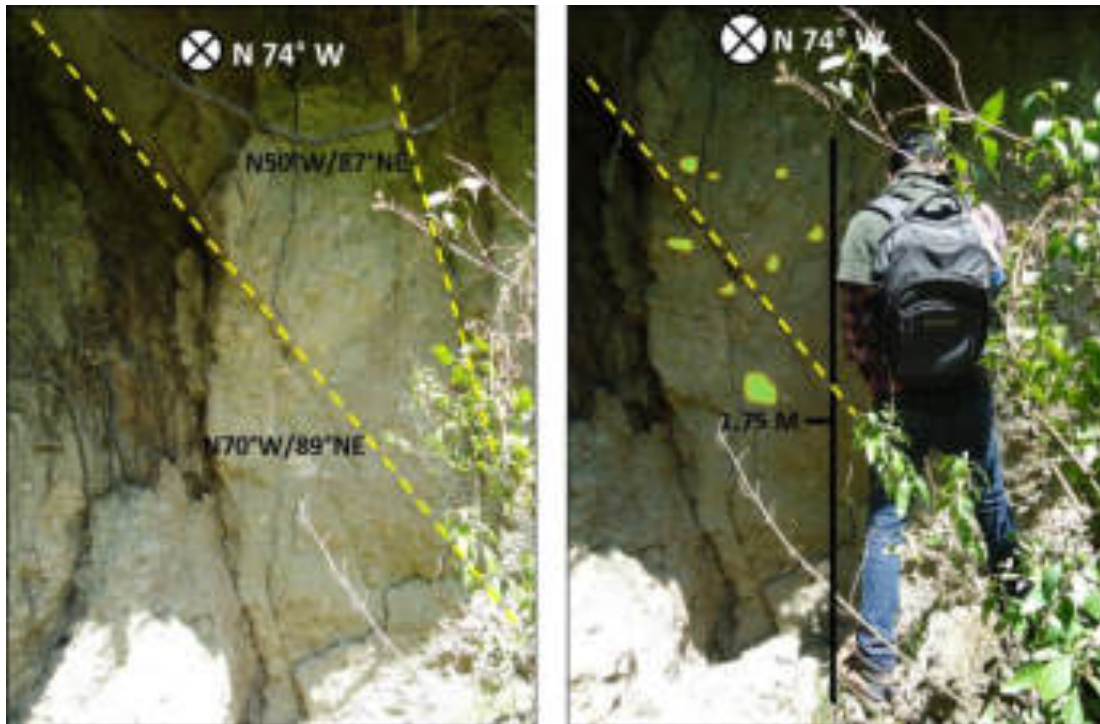
Figura 5.15 En la parte sur de la población de Jiquipilco, flujos piroclásticos Portezuelo cortado por fallas E-W y NW-SE. El flujo piroclástico presenta pómez y clastos de andesitas en una matriz de ceniza.
