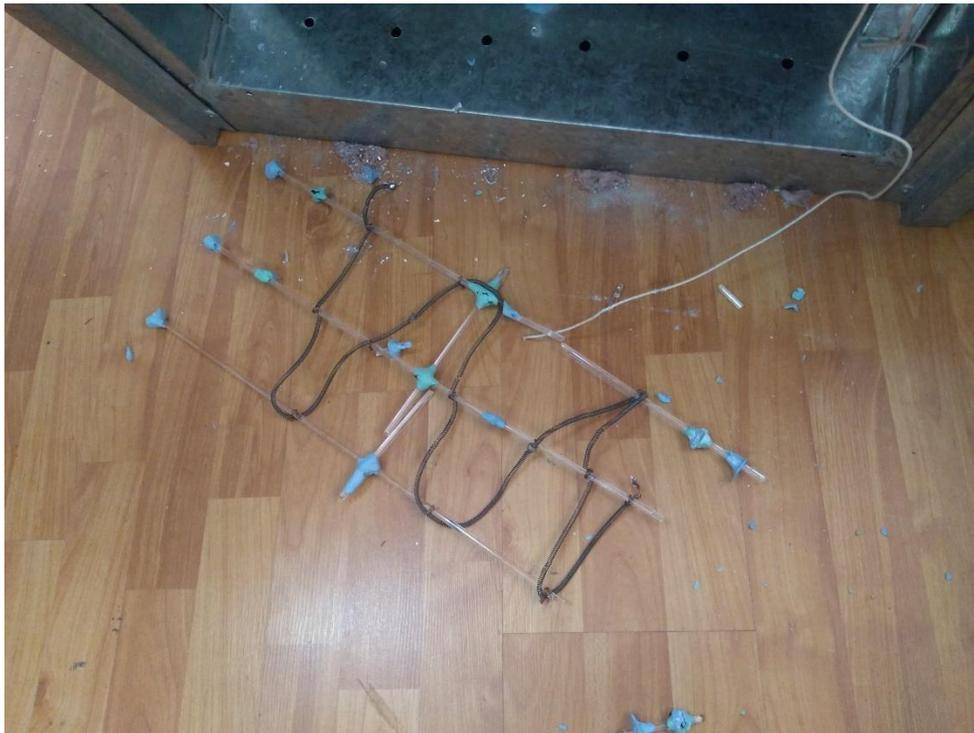
**Figura 4.6** Parrilla de varillas de vidrio con las resistencias en serie.
