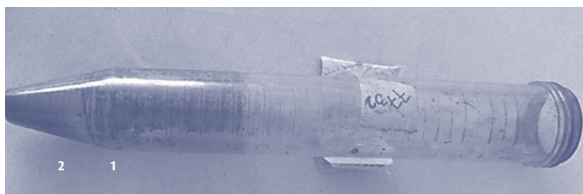
Figura 2: Tubo Falcon, indica la fuerte presencia de formación de biofilm en 1) superficie, 2) pared y 3) fondo.
