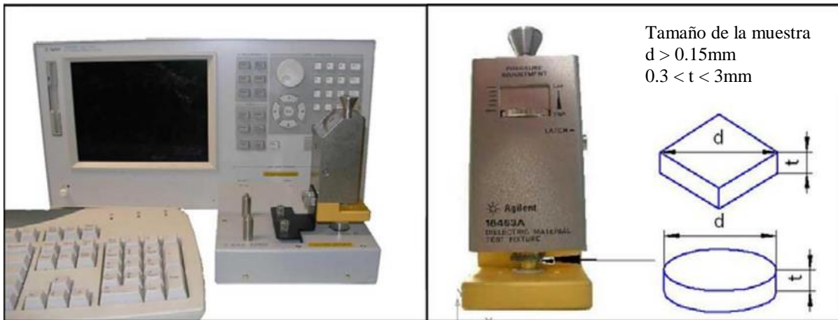
Figura 18. Analizador de impedancia Agilent modelo E4991A, indicando el diámetro ( d ) y espesor ( t ) de la muestra.
