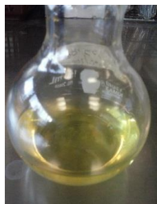
Figura 22. Reacción de epoxidación con formación in situ de ácido peroxiacético, usando resina de intercambio iónico ácida y apariencia del producto.
