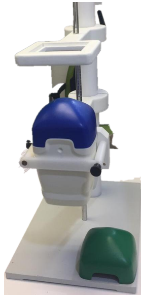
Figura 5.2: Arreglo geométrico de cámara y soportes sobre el mismo eje.
