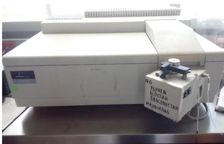
Figura 3.6. Espectrofotómetro UV-Vis, situado en el laboratorio de química ambiental del CCIQS. Empleado para medir la absorbancia de NPs de Bi y \text{Bi}_2\text{O}_3 suspendidas en agua desionizada
