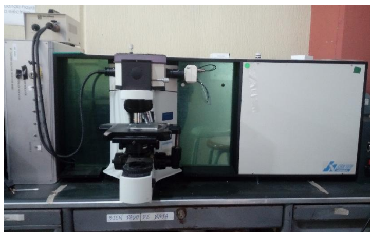
Figura 3.4. Espectrómetro Raman localizado en el laboratorio de espectroscopia Raman y procesamiento de materiales, Facultad de Química UAEMex, unidad Rosedal. Empleado para la medición de espectros Raman de las NPs de \text{Bi}_2\text{O}_3 .
