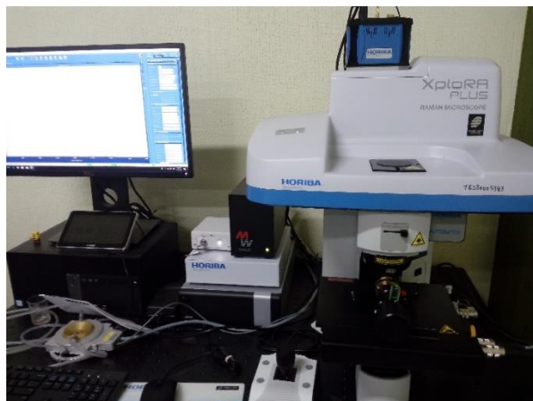
Figura 3.3. Espectrómetro Raman localizado en el TESJo. Utilizado para la medición de espectros Raman de las NPs de Bi
