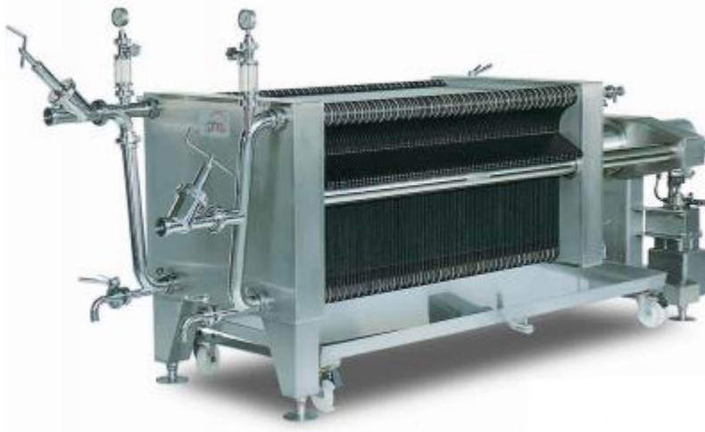
Ilustración 7.4 Filtro de placas
